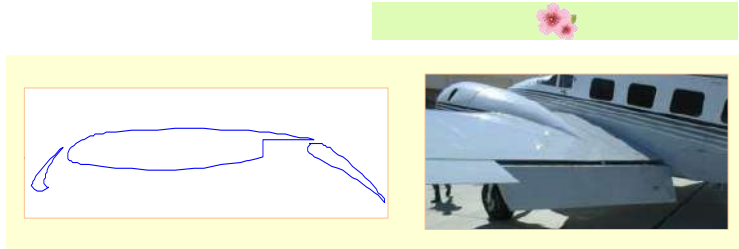
Şekil 1.68 Üç parçalı kanat profili örneği (46) .
