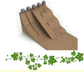
Şekil 1.5 “En kısa sürede varma” probleminin analitik çözümü dönele geometrisini verir (10) .
